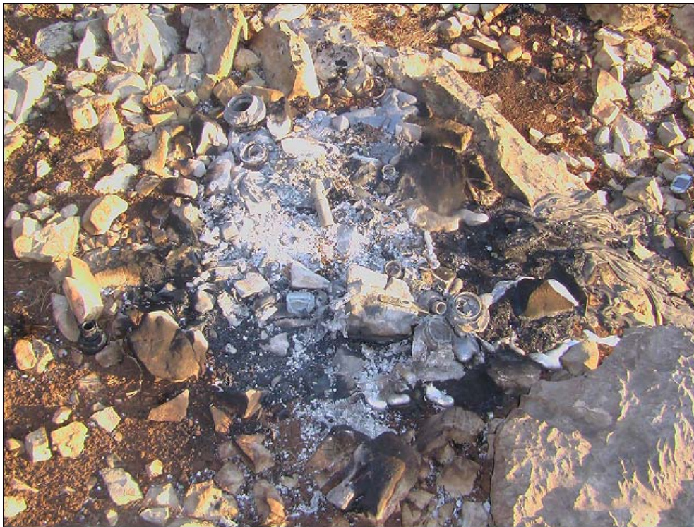
Slika 8.6. Potpuno rastaljeni aluminijski nosač sa crijevom snimljen na mjestu nesreće. Snimili vatrogasci 31. kolovoza 2007.
