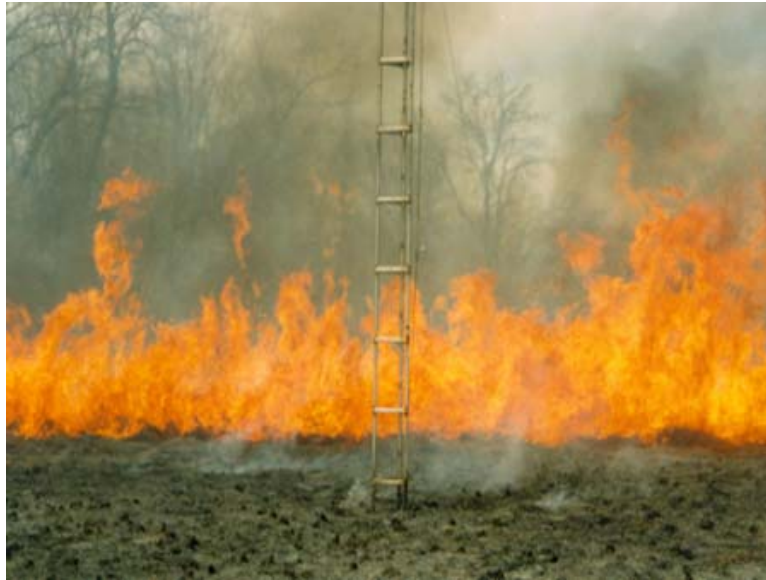
Slika 6.31. Pokus mjerenja vertikalnog profila temperature izgaranja i trajanja gorenja (Matchedash fire, 2000)
