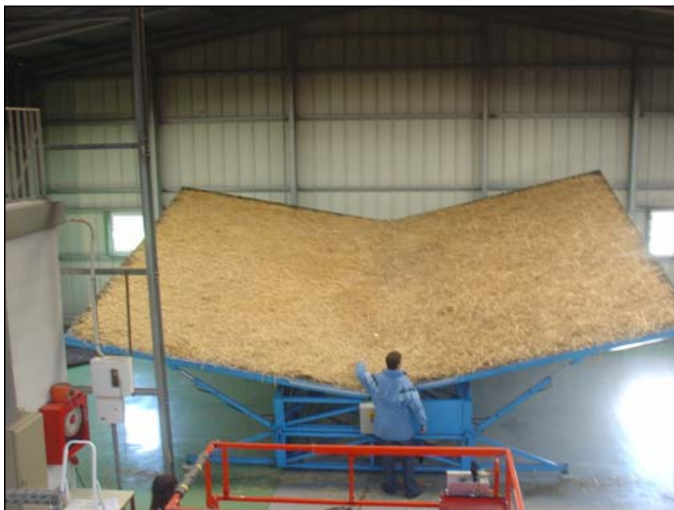
Slika 6.62. Veliki eksperimentalni stol za pojednostavljeno modeliranje konfiguracije klanca
