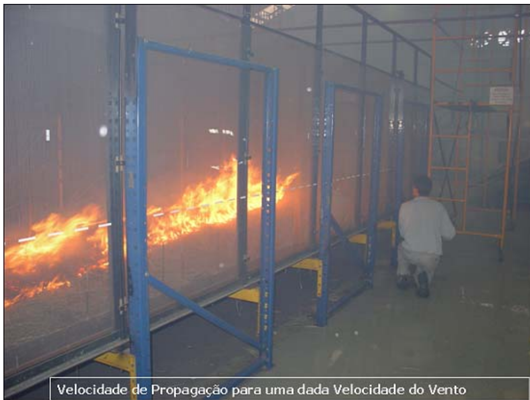
Slika 6.58. Pokusi vezani s određivanjem utjecaja vjetra na širenje požara na travnatoj podlozi
