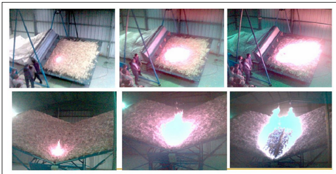
Slika 6.51. Pokusi Prof.Viegasa s eruptivnim požarima koji su rezultirali matematičkim modelom eruptivnog efekta – gore na kosini, dolje u klancu (slike su snimljene za vrijeme posjeta prof.dr.sc. Darka Stipaničeve laboratoriju prof.Viegasa)
