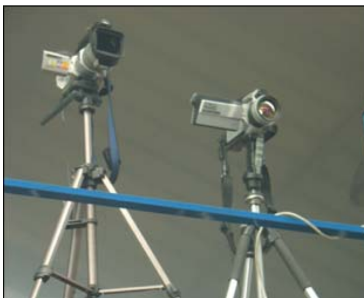
Slika 6.63. Snimanje pokusa termičkom i video kamerom
